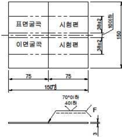
나) 스테인리스강 맞대기 용접
