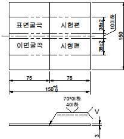
나) 스테인리스강 맞대기 용접
